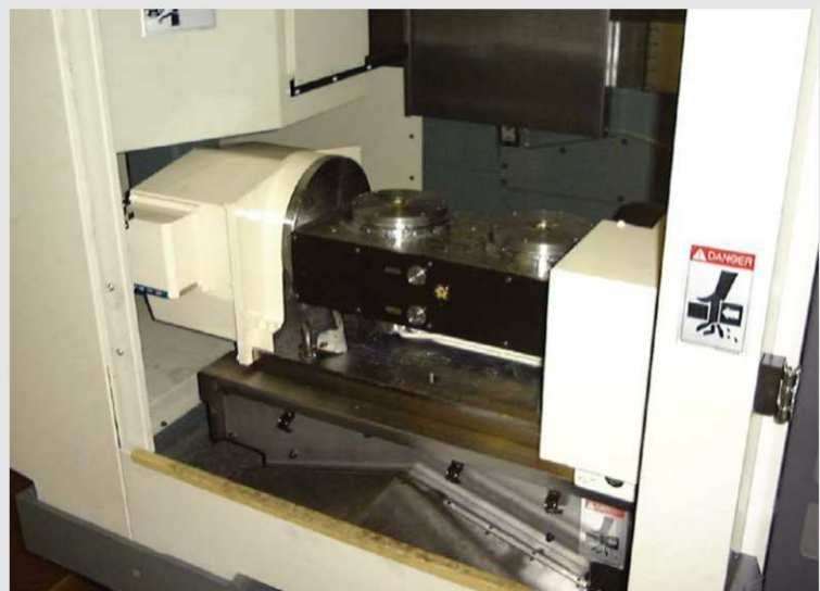
テーブル上にチルト式旋回装置を搭載した例です。 Example of fixture: Tilting device on the table.
