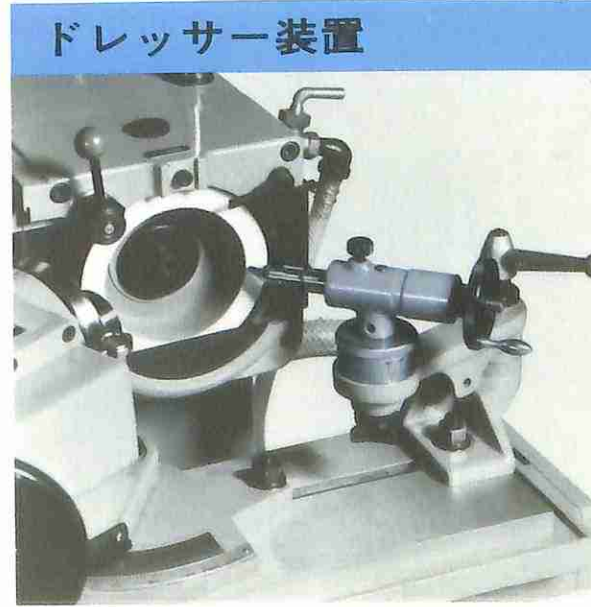
●ドレッサー 専用ドレッサー装置により、砥石の各面のドレーシングができます。
