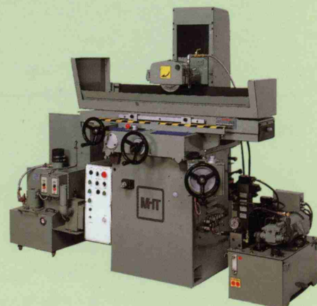
全自動精密成形平面研削盤 ●テーブル移動量(前後×左右) 230×480mm(250×500mm)
