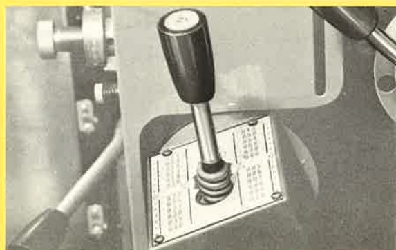
送り速度変換はエプロンの作業位置ででき、しかもこの位置に送り表があるために送りの選定、切換が迅速にできます。
