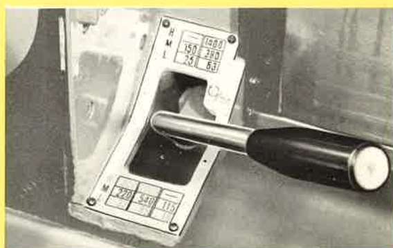
主軸の速度変換はエプロンの作業位置ででき、しかもこの位置に速度表があるために速度の選定は迅速に行なわれます。
