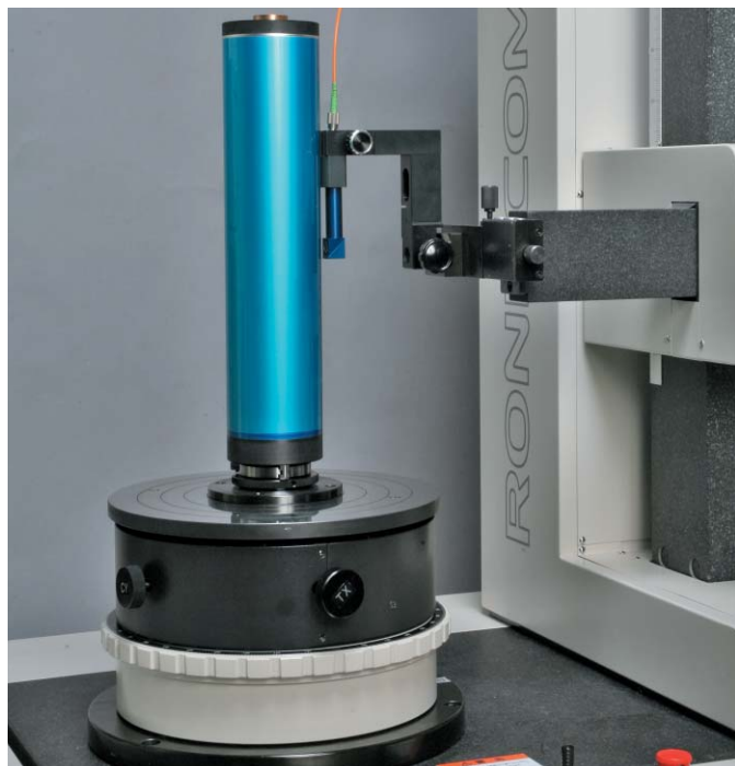
非接触検出器による真円度測定例
