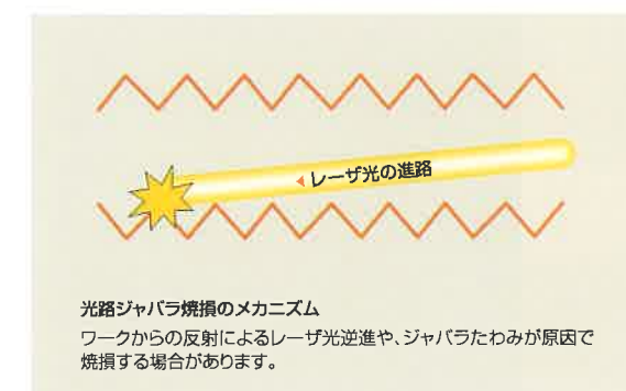
焼損検知光路ジャバラ
