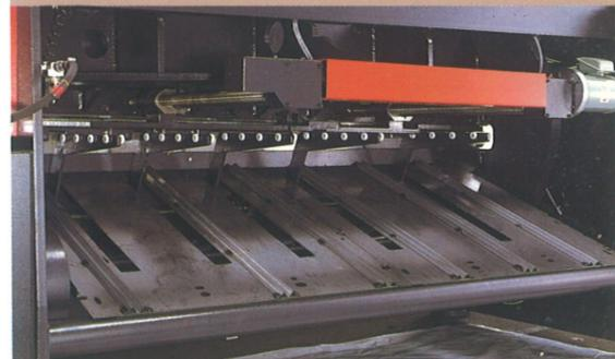
非磁性材用の後部材料支持装置。薄幅広切断において、高い精度が得られ、サポートアームにプラスチックローラーを装備しているため、材料にキズが付きません。また、使用しない時はシューターの下に格納できます。
