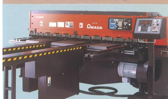
シャーリング作業のフロント位置決めをNC制御する自動定寸装置。ワーク位置決め段取り時間を大幅に短縮、材料のダレもなく、誰でも簡単に高精度加工が行えます。NC加工後の多数個取り切断やトリミング加工にも威力を発揮。最大999工程(99プログラム)を入力・記憶できるほか、自己診断機能、アラーム表示など多彩な機能を搭載しています。
