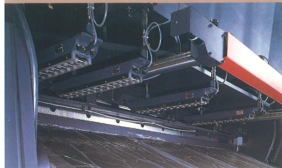
軟鋼材、磁性材用のマグネット式サポート装置。ダイヤル操作による磁力調整で、支持力を板厚に合わせることができ、s.p.m. を落とさずにマシンの能力を十分に発揮することができます。
