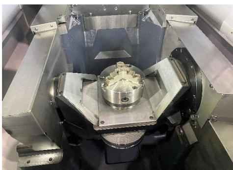
北川鉄工所製6吋3爪スクロールチャック
