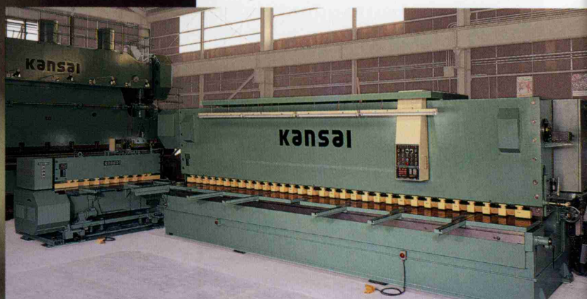
2面切断シャー 4.5mm×7000mm・4.5mm×2000mm (型式 GS-4.57000・AS-4.52000)
