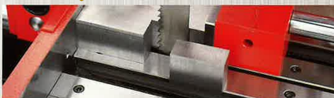
切り残しゲージを使用した加工例
