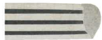
ヘリ継手溶接の断面マクロ
