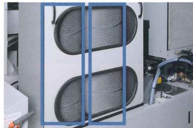
フィルタ自動切替 フィルタ圧力に応じて自動的に使用する フィルタAとBを切替(フィルタ4本仕様が必要です)
