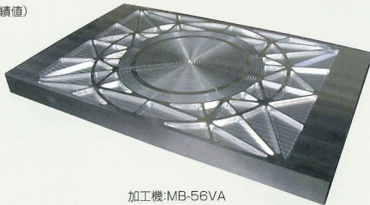
加工機:MB-56VA 加工部品:液晶関係部品 材質:A5052 寸法:800×500×100
