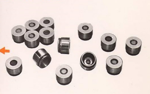
シリンダヘッド (11A) アルミニウム合金 取りしろ片面2.0 両面研削 平行度0.01 平面度0.01 寸法差±0.01 面アラサ6S 72個/時間
