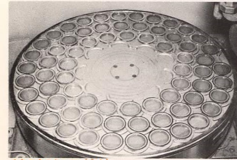
メカニカルシール (9A) 特殊鋳鉄(HRC65) 取りしろ片面0.5 両面研削 平行度0.02 寸法差±0.015 面アラサ0.8S 110個/時間
