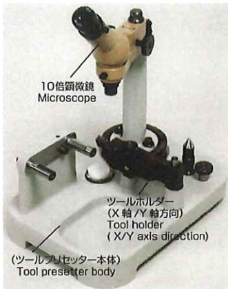
①バイトの刃先をX軸方向とY軸方向に合わせます。 Sets the X/Y axis direction
