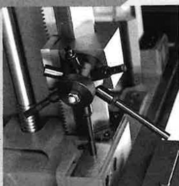
6段ストップバ(MSタイプ) 6本の異なった位置決め棒により、そ れぞれ異なった長手方向の位置決めが 可能です (ただし、自動送りを停止させることはできません)
