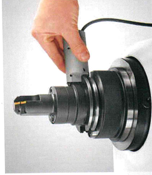
読み取り / 書き込みヘッドの手動位置決め Manual positioning of the read/write head
