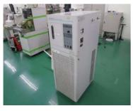
・電源投入温度表示 確認電源ランプ点灯 確認ポンプ、冷凍機ランプ点灯 確認
