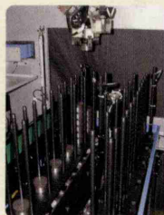
ステーションストック ワーク径の変更にも柔軟に対応可能な多段階積み型ストックです。
