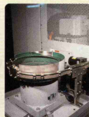
パーツフィーダ スペースをとらない小物ワークを対象とした円筒型のストックです。コンベアへの直結が可能です。
