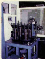
ステーションストック ワーク径の変更にも柔軟に対応可能な多段階積み型ストックです。
