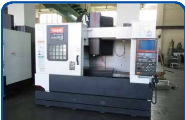
#40立形マシニングセンタ(ヤマザキマザック) 2007年 VCN510C-II 電源 MATRIX
