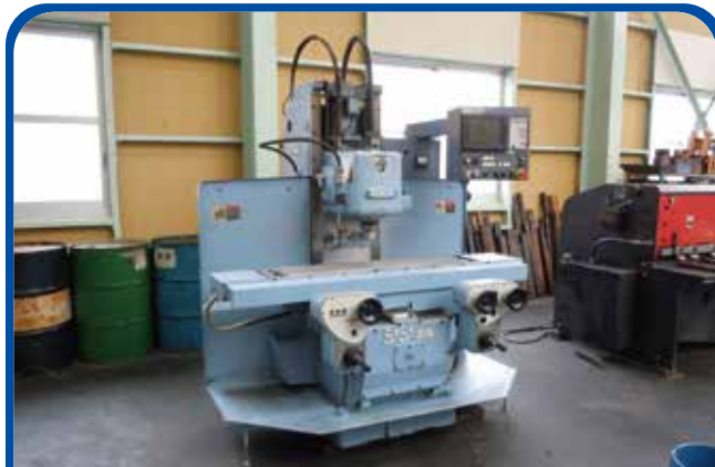
NC立形フライス盤 (OKK) 2008年 RRM-2V 電源 MELDAS
