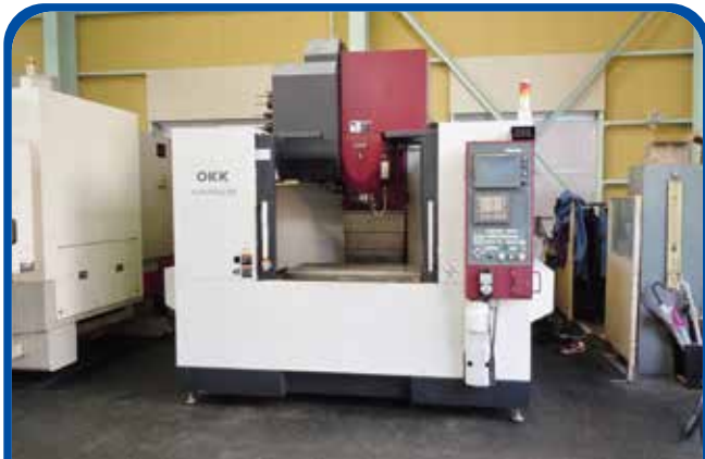
#50立形マシニングセンタ(OKK) 2007年 VM-5III 電源 FANUC-180is-MB
