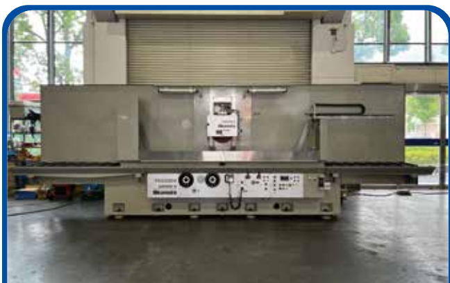
2000mm×600mm 平面研削盤(岡本工作機械) 2010年 PSG206DX
