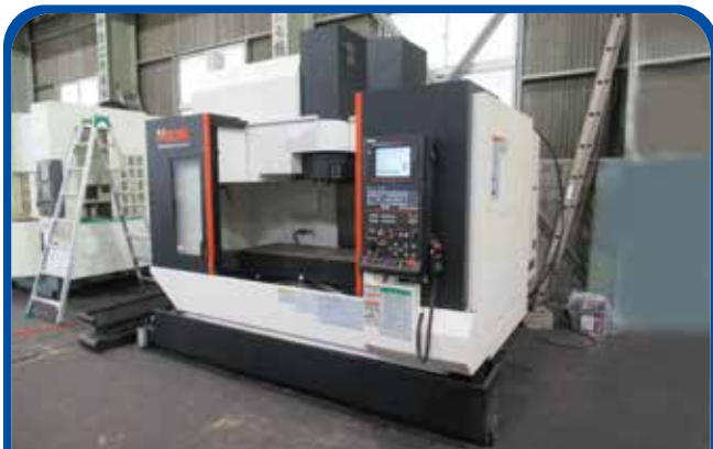
#40立形マシニングセンタ(ヤマザキマザック) 2015年 VCS530CLH 電源 MAZATOROL-smart
