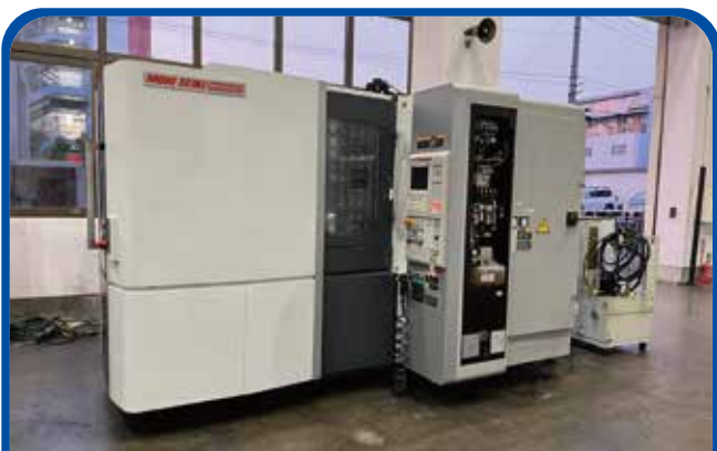
#40横形マシニングセンタ(森精機) 2013年 NHX4000 電源 M730BM
