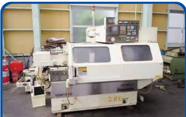
NC内面研削盤(岡本工作機械) 2007年 IGM15NC 電源 FANUC-18iTB
