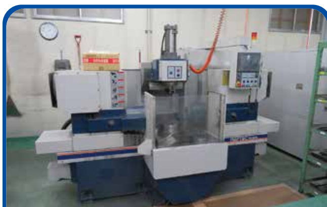
NC両頭フライス盤(武田機械) (高崎) 2003年 HDS430NC 電源 FANUC-PMi-H 680万円 税込748万円
